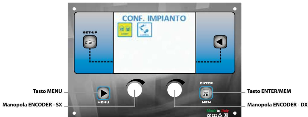
All'interno del *Menu EQUIPMENT LAYOUT*, è possibile scegliere, ruotando la **MANOPOLA ENCODER - SX**, il componente dell'impianto di saldatura, mentre ruotando la **MANOPOLA ENCODER - DX**, si può decidere il tipo di collegamento desiderato (Es. Facoltativo) o il tipo di componente (Es. Torcia 400 A H2O) che dovrà essere collegato all'impianto (**l'operazione non necessita di conferma**).
