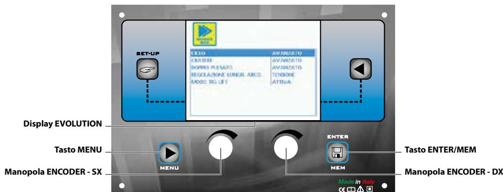
All'interno del *Menu ADVANCED MODE* è possibile scegliere, ruotando la **MANOPOLA ENCODER - SX**, il modo di saldatura avanzato desiderato, tra i **4** disponibili (a seconda del processo di saldatura selezionato) e lo si può **ATTIVARE (l'operazione non necessita di conferma)** ruotando la **MANOPOLA ENCODER - DX**.
