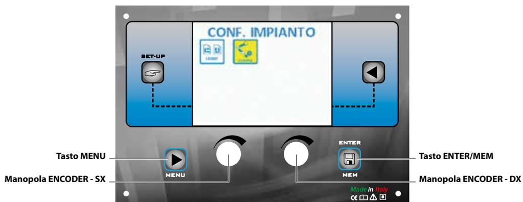
All'interno del *Menu CONFIG*, è possibile scegliere, ruotando la **MANOPOLA ENCODER - SX** l'attivazione della configurazione per robot.
