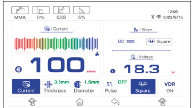
**(F) Pulsante di accesso all'interfaccia di saldatura:** In qualsiasi caso, premere questo tasto per accedere all'interfaccia finale di saldatura.
